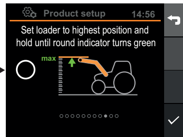
9. Paina kuormainta mekaanista estettä vasten ohjaussauvan täydellä poikkeutuksella, kunnes osoitin muuttuu vihreäksi (3 - 4 s). Vahvista valintamerkillä.
