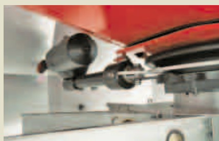
Spesialforseglede motorer motstår all fare for korrosjon
