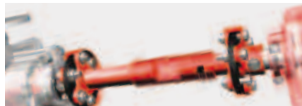
Drev for spredeskiver med to beskyttende gummikoblinger
