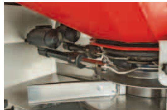
To aktuatorer på hver doseringsenhet for å styre utslippspunktet og spredemengden
