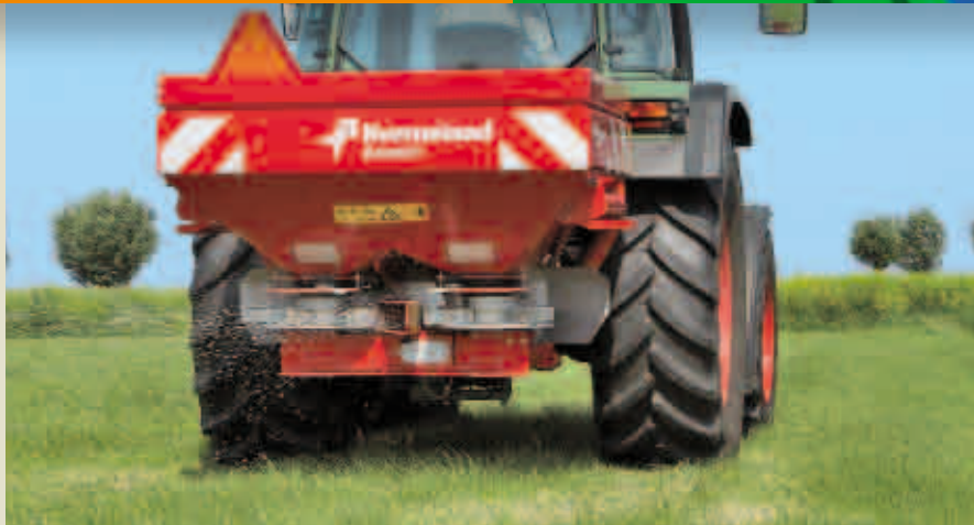
Kantgjødsling ved bruk av kantgjødslingsplate
