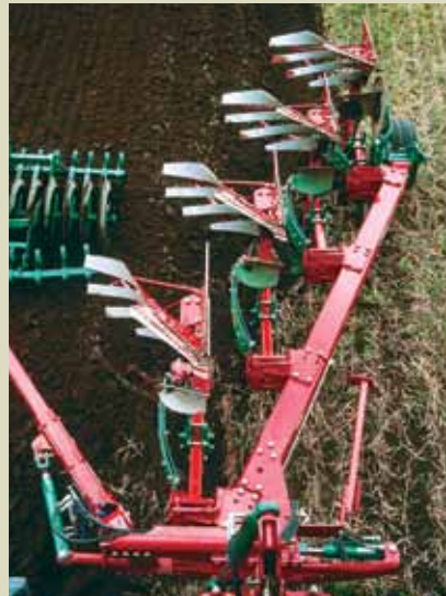
Et helt gjennomgående rammerør gir styrke og fleksibilitet.
