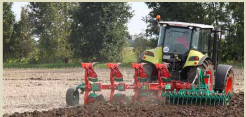
Et helt gjennomgående rammerør gir styrke og fleksibilitet.
