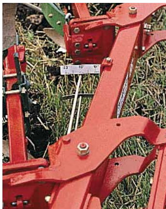
Trinnløs innstilling av arbeidsbredden fra 30 til 45/50 cm (12 - 18/20")
