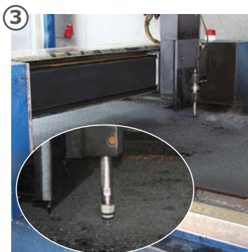
baserat på den CAD-skapade ritningen skärs slitsarna exakt ut i mattorna med innovativ vattenstrålteknik
