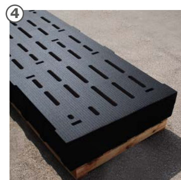
baserat på den CAD-skapade ritningen skärs slitsarna exakt ut i mattorna med innovativ vattenstrålteknik
