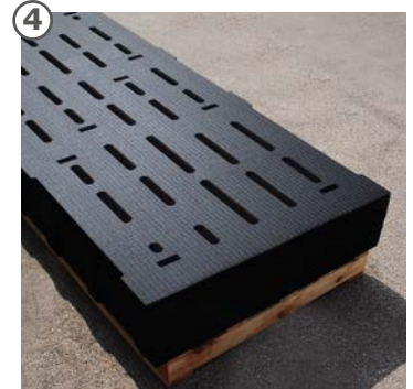
baserat på den CAD-skapade ritningen skärs slitsarna exakt ut i mattorna med innovativ vattenstrålteknik
