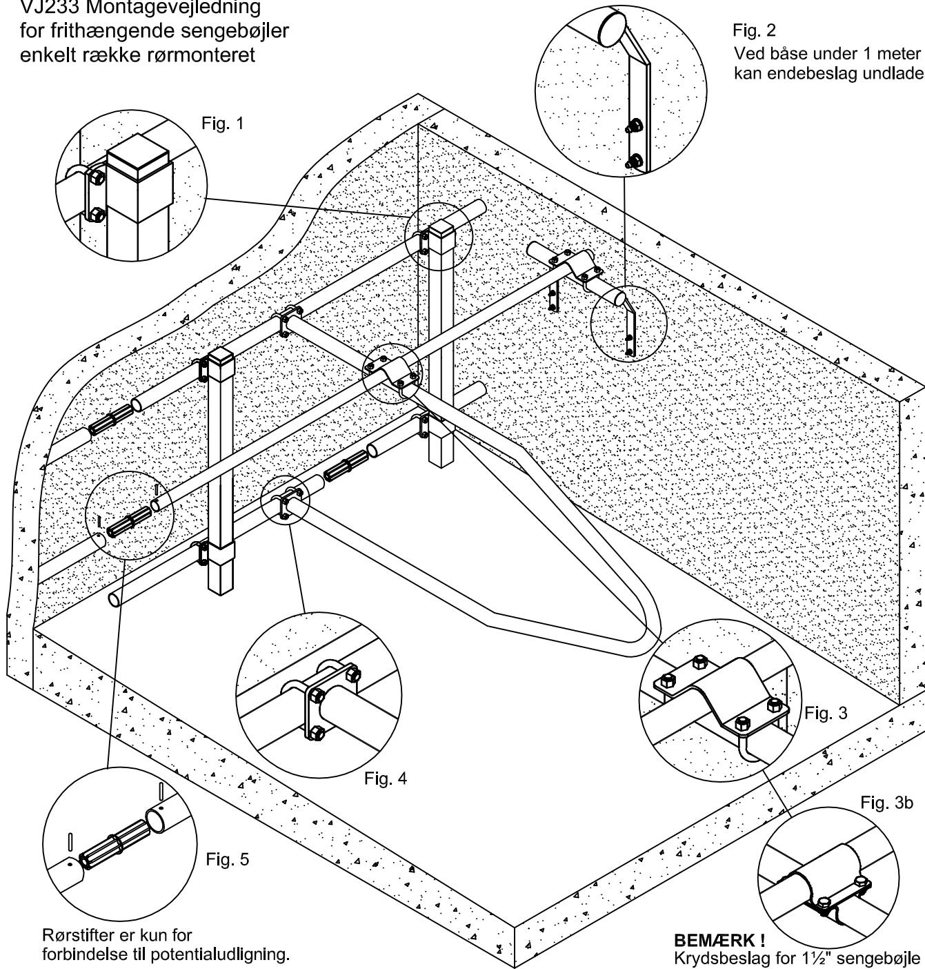
**Fig. 1** Monteres med: 2"x12mm rørbøjle, M12 låsemøtrik og M10x16 umbraco
