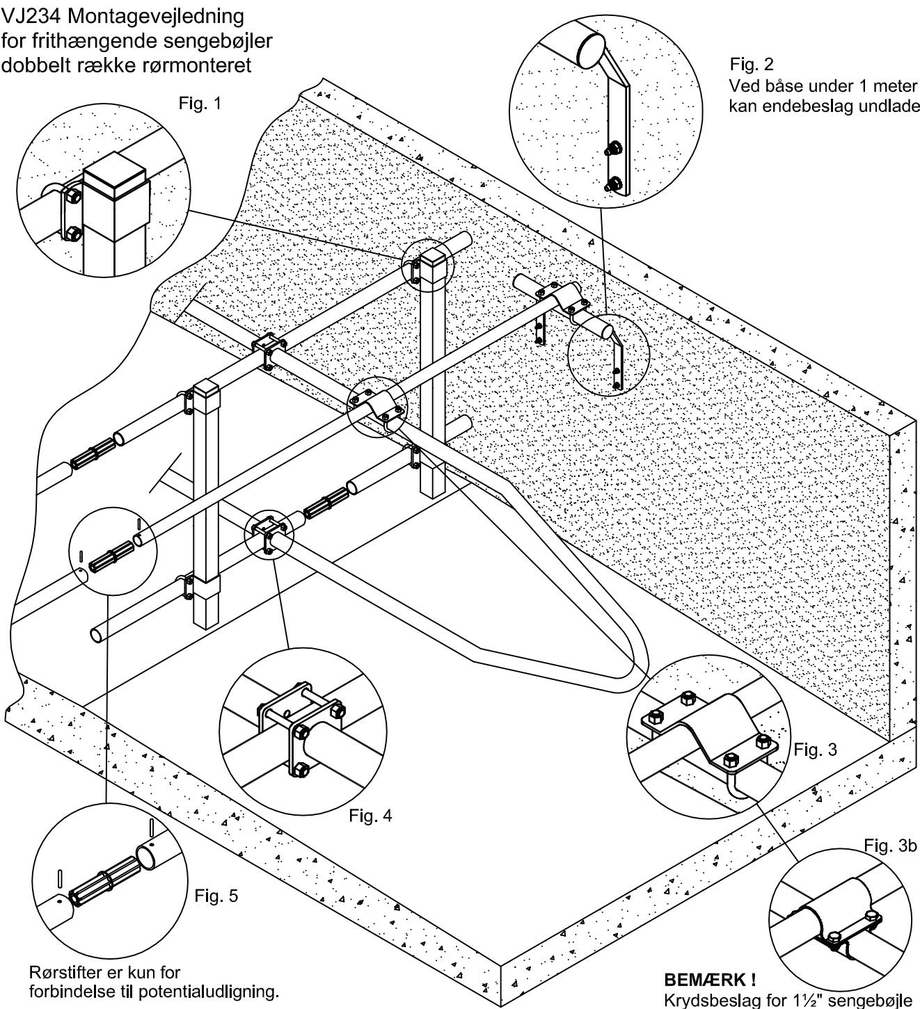
**Fig. 1** Monteres med: 2"x12mm rørbøje, M12 låsemøtrik og M10x16 umbraco
