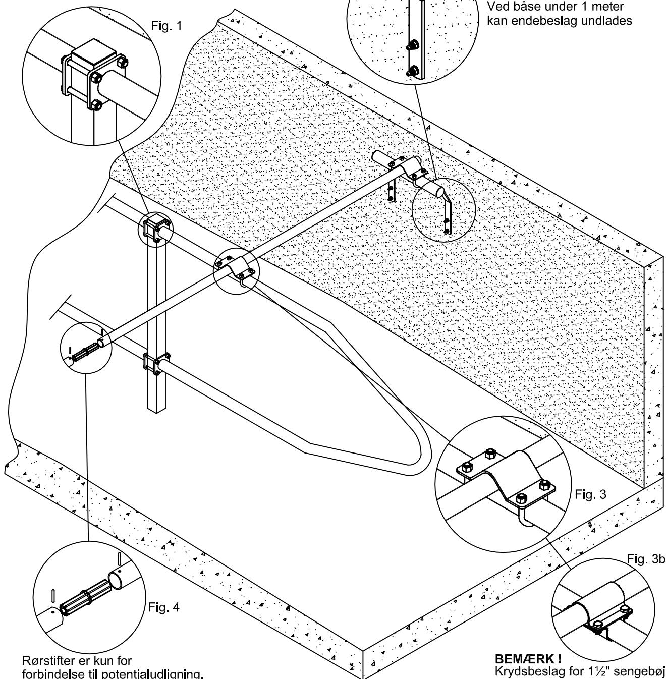
**Fig. 1** Monteres med: M12x110 maskinbolt og M12 låsemøtrik
