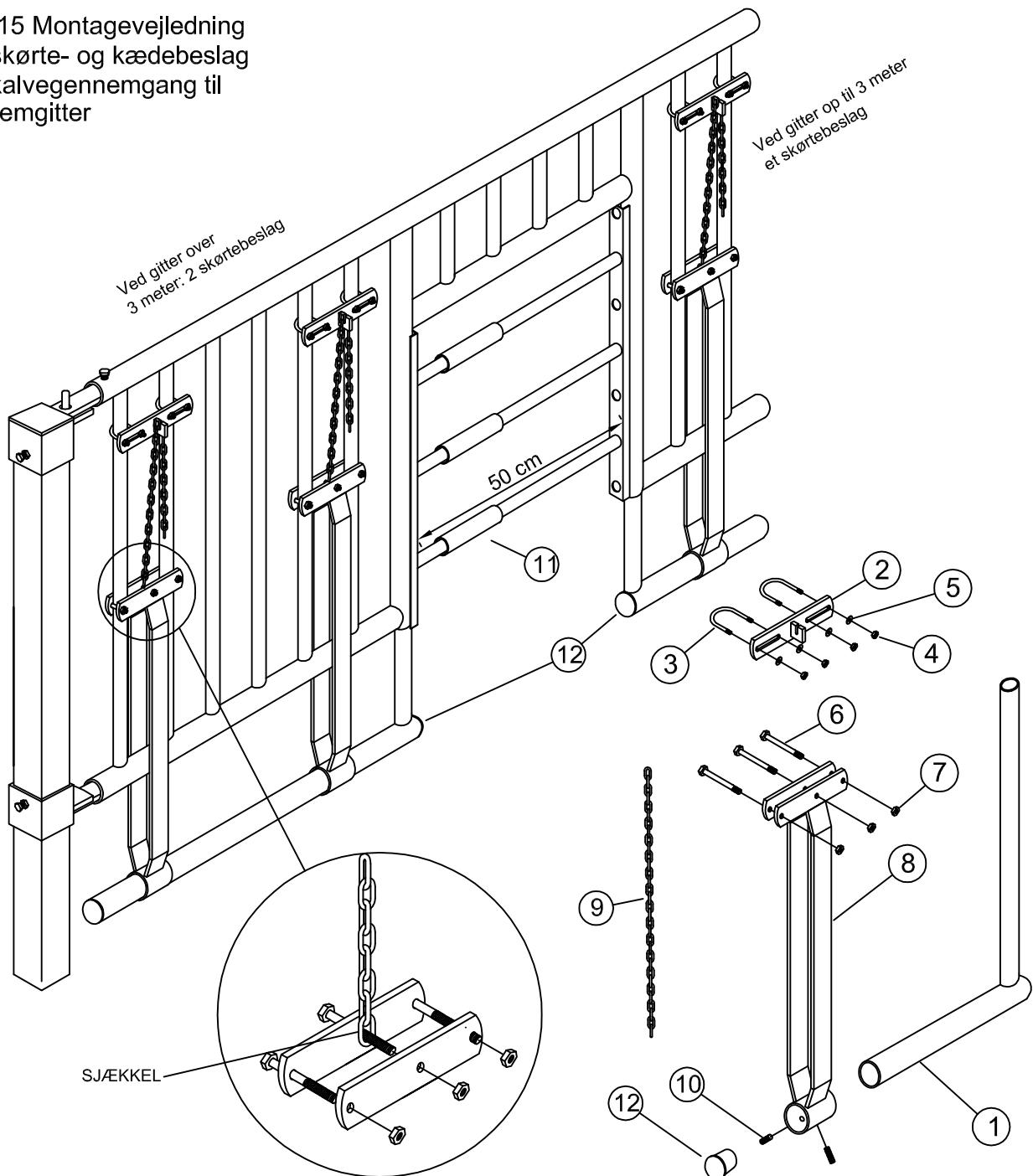
Fig. 1 2" skørt for kalvegennemgang
